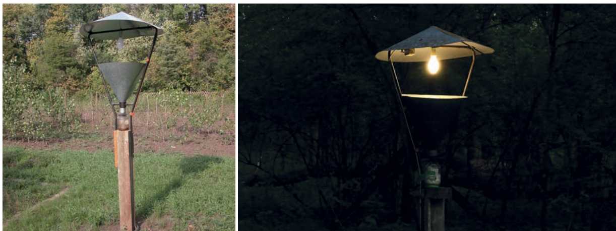
Az Erdészeti Fénycsapda Hálózat szabványos csapdája nappal és éjszakai működés közben ©CsGy
