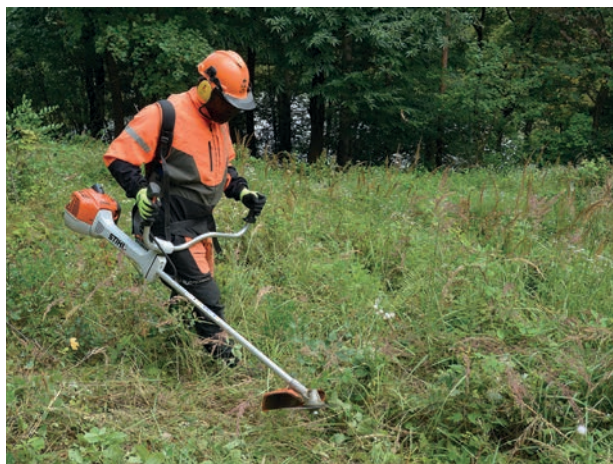
Az adapteres tisztítófűrész az erdősítések ápolásának gyakori eszköze ©NCs
