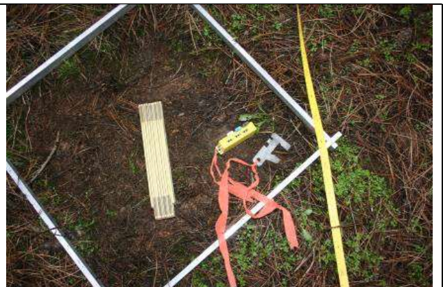
Abbildung 7. Lineare Probenahme mit kombinierter Aufzeichnung unter Verwendung eines „Go-No-Go“-Geräts
