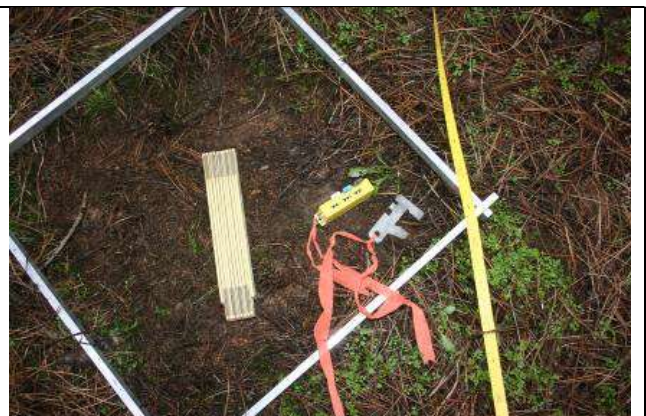
Slika 7. Linearno uzorkovanje s kombiniranim snimanjem pomoću uređaja "go-no-go"
