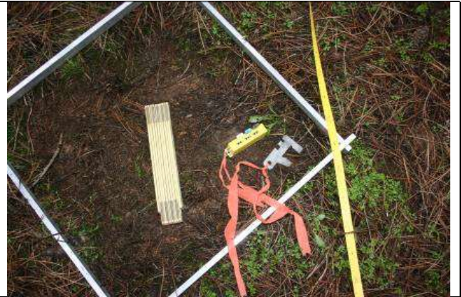
Ábra 7. Vonalas mintavétel „go-no-go” eszközzel kombinált felvételezéssel
